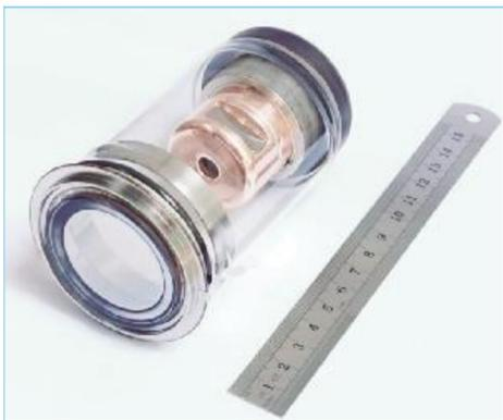
光阴极 X 射线管 中科院西安光学精密机械研究所供图
