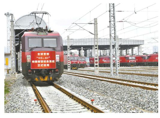
9月4日14时46分,首台搭载5G设备的402号"和谐HXD3D"型大功率电力机车驶入西安机 务段机车整备场。不到 90 秒的时间, 15.6GB 的机车视频数据自动转储完成, 标志着"5G+AI 智慧机 务系统"正式投用。这是在全球范围内首次在铁路机车上应用 5G 技术。
